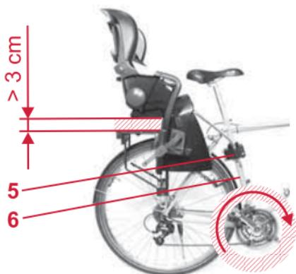
**So positionieren Sie die Halterung **9** richtig am Fahrrad:**
