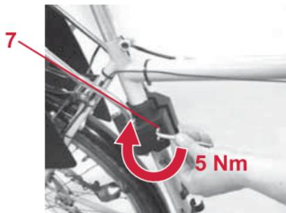
☞ Dra åt skruvarna **7** på fästet **5** med en insexnyckel (storlek 5) med et vridmoment på 5 Nm. Använd provstycket **X** för att erhålla ett korrekt fäste.
