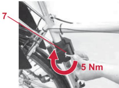
☞ Stringete le viti **7** del supporto **5** con una chiave per viti ad esagono cavo (misura 5) con una coppia di serraggio di 5 Nm. Utilizzate il pezzo in prova **X** per assicurare un corretto fissaggio. Verificate con il pezzo in prova **X** che la fessura del raccordo a vite **7** non sia più larga di 8 mm (lato spesso del pezzo in prova) e non più stretta di 5 mm (lato sottile del pezzo in prova).
