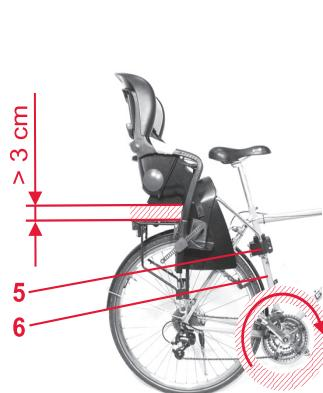
**So positionieren Sie die Halterung **9** richtig am Fahrrad:**
